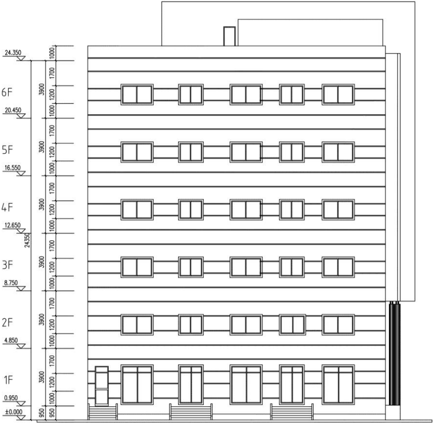
East elevation 1:100 东立面 1:100
